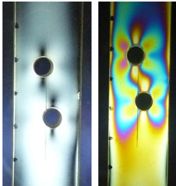
Fig. 5.-Probeta fotoelástica bajo carga de tracción constante a temperatura ambiente (izquierda) y por encima de la temperatura de transición vítrea del material (derecha)
