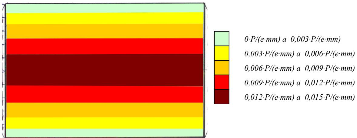
Fig. 26.4.- Representación de la componente  $\tau_{xy}$
