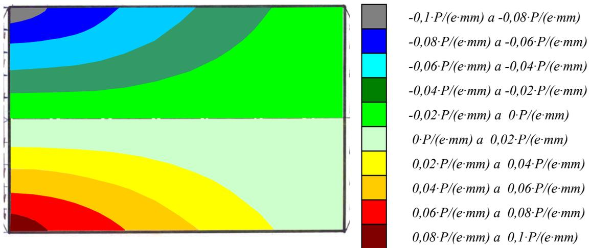
Fig. 26.3.- Representación de la componente  $\sigma_{xx}$
