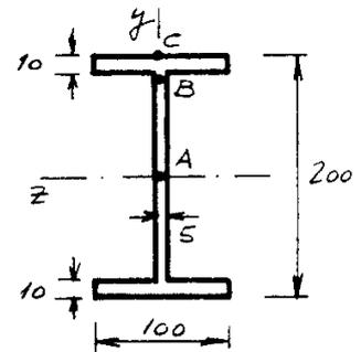
**3.3.-** La viga de la figura está constituida por un perfil IPN 200. Hallar, en cm, la longitud para la cual son iguales la tensión normal máxima y la tensión tangencial máxima. 18-9-08
