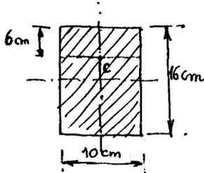
Calcular las tensiones principales en el punto C indicado en la figura, de la sección recta que está situada a 80 cm del empotramiento. 5-9-95
