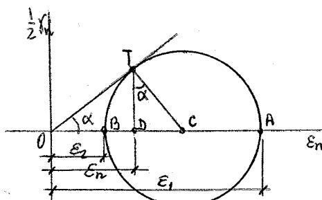
El ángulo  $\alpha$  es máximo cuando el punto representativo en el círculo de Mohr es T. De la figura se deduce:  $E_n = \overline{OD} = \overline{OC} - \overline{DC}$
