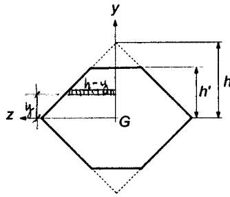
De la fórmula de Navier  $\sigma_{\max} = \frac{M_z}{W_z}$  se deduce que la sección será de máxima resistencia a la flexión cuando es máximo el módulo resistente.
