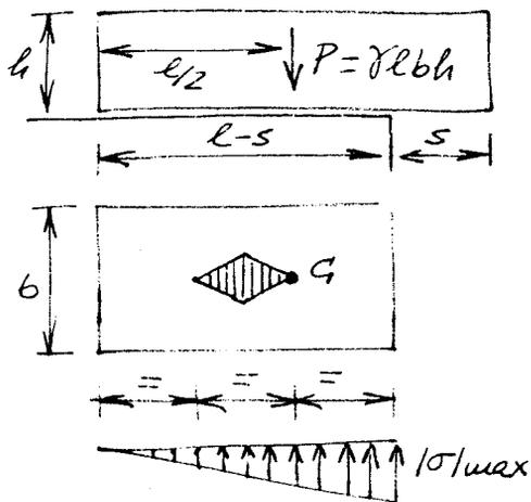
Se tendrá que verificar que  $P$  pase por el vértice del núcleo de la sección de apoyo:
