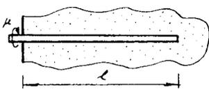
2.- Una barra corrugada está hormigonada dentro de un muro como indica la figura. Al intentar girarla alrededor de su eje aplicando el par  $\mu$ , la adherencia se opone con un momento por unidad de longitud constante. Determinar en estas condiciones el diagrama de momentos torsores en la barra y el giro relativo de sus secciones extremas. Datos:  $G, I_0$
