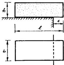
4.- Un macizo en forma de paralelepipedo, de dimensiones  $l \times b \times h$  y peso específico  $\gamma$ , se apoya parcialmente sobre otro de su mismo material, tal como indica la figura. Se pide determinar la máxima distancia  $s$  que puede sobresalir el macizo superior para que existan compresiones sobre toda la superficie de contacto, así como la tensión máxima de compresión producida.
