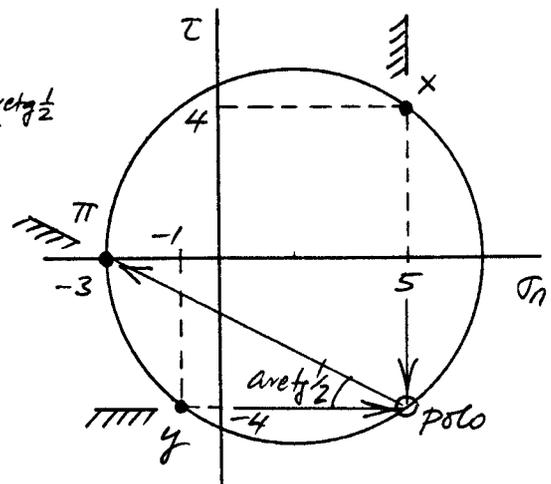
Situamos en el diagrama de Mohr los puntos representativos de los planos coordenados (eje x, horizontal; eje y, vertical) = (5, 4) y (-1, -4) respectivamente.
