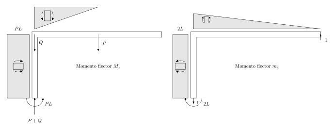
Se observa en la figura de la izquierda que la fuerza de compresión Q no crea momento flector en ningún miembro. Como sólo intervienen deformaciones por flexión la energía elástica del sistema es:
