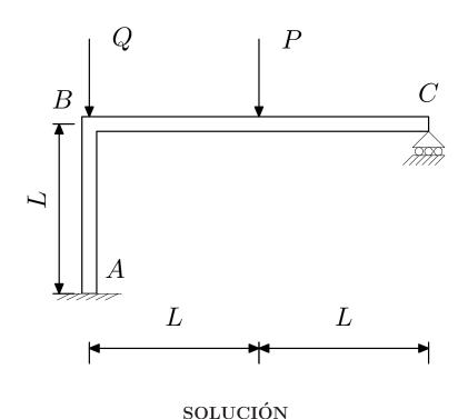
Para conocer el estado tensional en todas las secciones de la columna AB obtenemos primero las leyes de esfuerzos en todos los miembros del semipórtico. Después estudiamos las tensiones en AB, que está sometido a flexión compuesta y escogemos el mínimo valor de Q que anule todas las tensiones de tracción debidas a la flexión en la columna.
