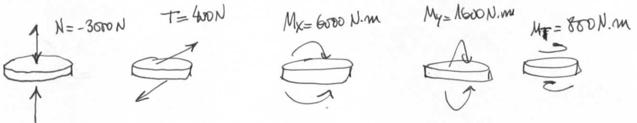
b) Tensión normal máxima y equivalente (según Tresca)
