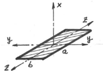
Plano de pandeo indeterminado:  $\lambda^{xz} = \lambda^{xy} \rightarrow l_p^{xz}/I_y = l_p^{xy}/I_z$
